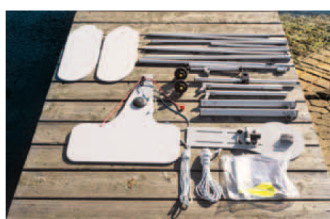
Die Einzelteile auf einen Blick. Auffällig ist das große und stark vorbalancierte Ruderblatt
