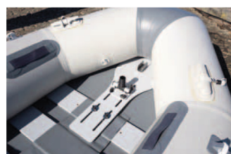
Der Mastfuß sitzt auf einer Bodenplatte. Deren Form richtet sich nach dem Schlauchboottyp
