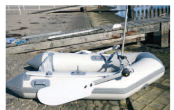
Die Schwertbrücke wird an zusätzlichen Dollenaufnahmen befestigt. Sie hält auch den Mast
